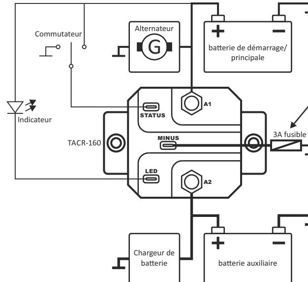
**! Avertissement** Le schéma de raccordement ci-dessus est destiné uniquement à des fins fonctionnelles. Placez toujours un fusible sur toute connexion provenant de la borne positive de la batterie et placez-le aussi près que possible de la borne de la batterie. Utilisez un diamètre de câble suffisant pour les lignes à courant fort A1 et A2 afin d'éviter toute surchauffe ou tout incendie (50 mm<sup>2</sup> ou plus). Établissez des connexions de câble solides et sécurisées.
